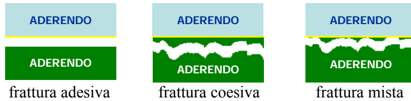
Figura 2-10 – Confronto tra le diverse tipologie di frattura.
